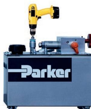
in modo efficiente e flessibile, ovunque e indipendentemente dall'alimentazione e dall'aria. L'aggraffatura dei tubi flessibili diventerà così molto più produttiva poiché avverrà in modo elettrico anziché manuale. La centralina 85CE-PDP funziona con qualsiasi avvitatore a batteria disponibile in commercio. Questo consente di usare la centralina in modo flessibile, in particolare nell'agricoltura, nella silvicoltura, nell'edilizia e nelle applicazioni idrauliche in mobilità.
