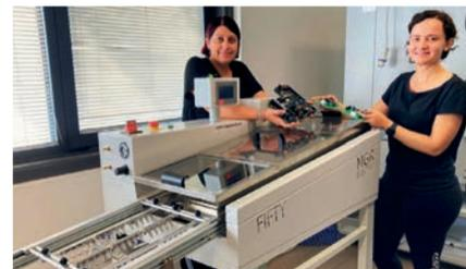
sua gamma con una linea di Assemblaggio, e continua ad essere all'avanguardia nella produzione di schede elettroniche. Permette di gestire internamente il montaggio e la saldatura di schede con tecnologia SMD (Surface Mount Device) e THT (Through-Hole Technology) per la realizzazione di prototipi e miniserie. È stata introdotta con l'obiettivo di aumentare l'autonomia, consentendo di ridurre i tempi di produzione e di offrire una maggiore flessibilità ai clienti.
