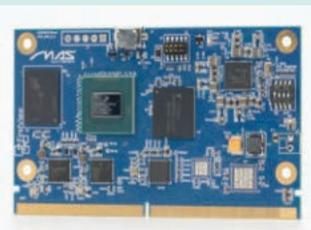
ne industriale delle immagini nonché in applicazioni di manutenzione predittiva attraverso il Machine Learning. Le caratteristiche della CPU AURORA IMX8M PLUS sono: Prestazioni ARM fino a 4x 1.8GHz Cortex-A53 e 1x Cortex-M7 a 800MHz; unità di elaborazione neurale (NPU): fornisce fino a 2,3 TOPS.
