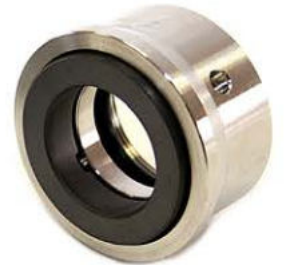
TIPO SGR5A ALTA PRESSIONE, BILANCIATA, BIDIREZIONALE PRODOTTA CON LEGHE SPECIALI.
