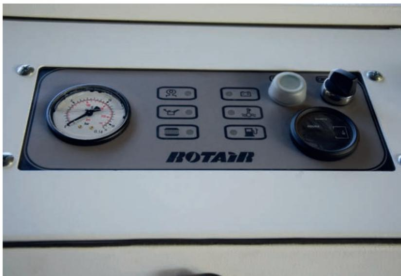
■ Tre modelli con pressioni di esercizio di 7 bar con portata d'aria compressa di 1100 l/min, 11 bar con 930 l/min e 13 bar con 800 l/min in condizioni ambientali da -10°C a 50°C
