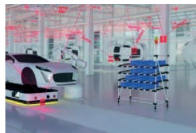
i segnali, che danno luogo a una visualizzazione digitale e completa del flusso di materiale, sono trasmessi in modalità wireless a un Sensor Bridge, che a sua volta comunica tramite un'interfaccia con i sistemi informatici sovraordinati per la gestione del flusso di materiali (ERP, PPC, WMS...).
