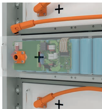
■ Panoramica di un modulo di stoccaggio con pacchi batteria, scheda BMS ed interfacce interne ed esterne
