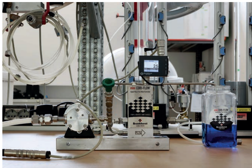
Misuratore di portata massica Coriolis in un sistema di dosaggio modulare
