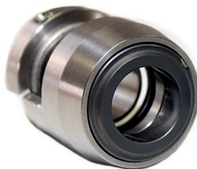
TIPO 85EGRTR ALTA PRESSIONE, BILANCIATA, BIDIREZIONALE, TITANIO.
